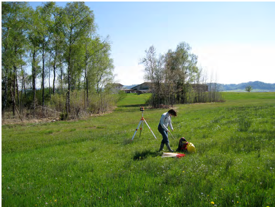
Abbildung 1: Die exakte Vermessung der Terrainhöhen ist die Basis für alle weitere Planungen.
