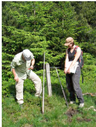
Abbildung 2: Die Aufnahme der Bodenprofile erfolgte mit einem verlängerbaren Bohrstock.
